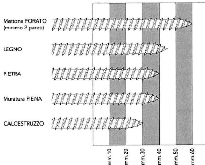
La lunghezza totale della vite, sarà individuata aggiungendo lo spessore del controtelaio e dello spazio tra controtelaio e muro.
