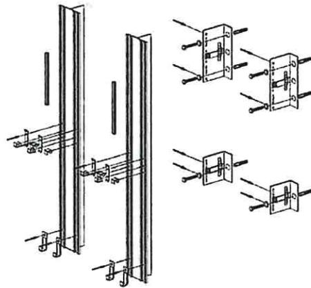
Sistema di facciata ventilata con montanti verticali
