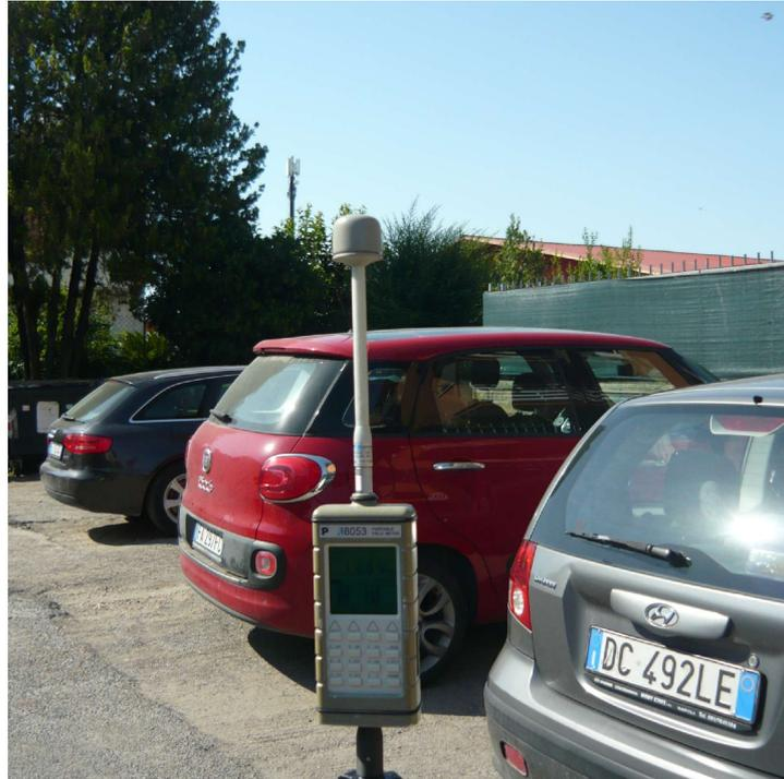
Fig. 33 Misura di Campo Elettromagnetico a RadioFrequenza – Punto #12
