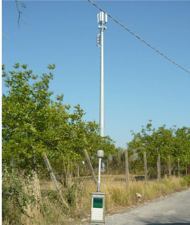
Fig. 39 Misura di Campo Elettromagnetico a RadioFrequenza – Punto #15
