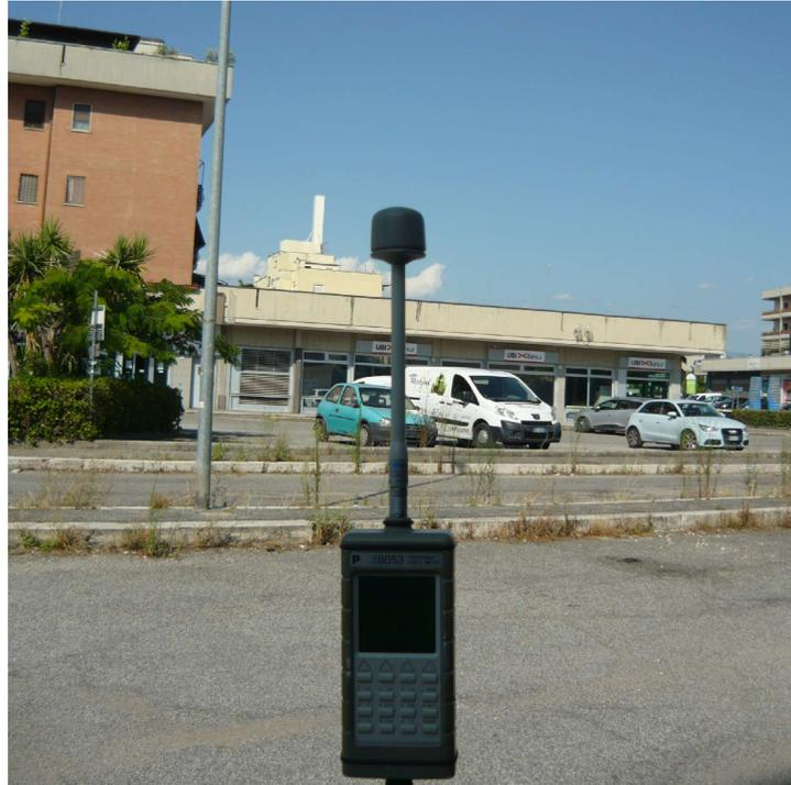
Fig. 35 Misura di Campo Elettromagnetico a RadioFrequenza – Punto #13
