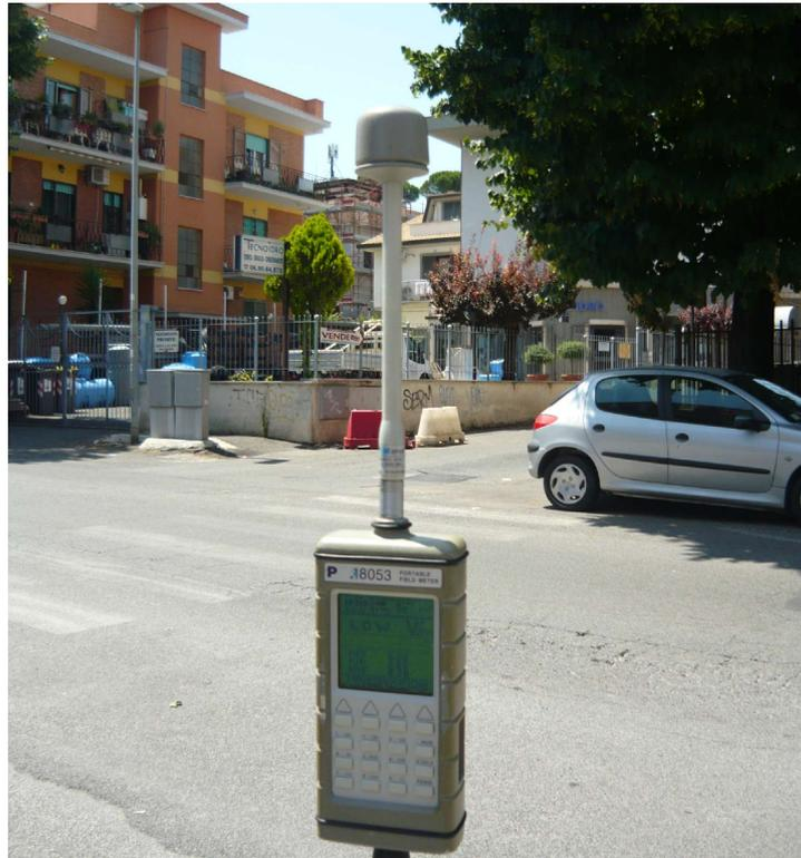
Fig. 21 Misura di Campo Elettromagnetico a RadioFrequenza – Punto #6
