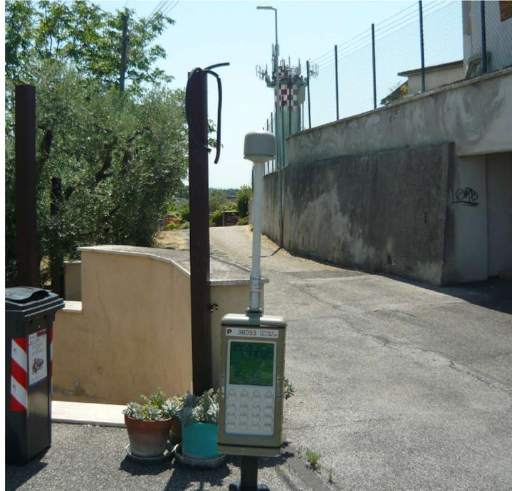
Fig. 19 Misura di Campo Elettromagnetico a RadioFrequenza – Punto #5
