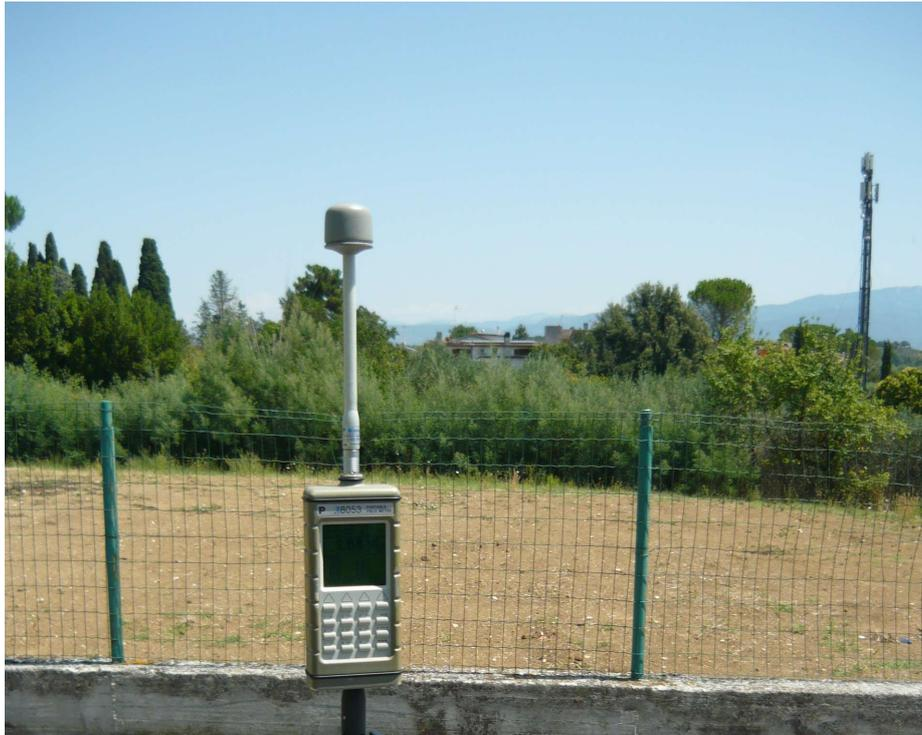
Fig. 11 Misura di Campo Elettromagnetico a RadioFrequenza – Punto #1
