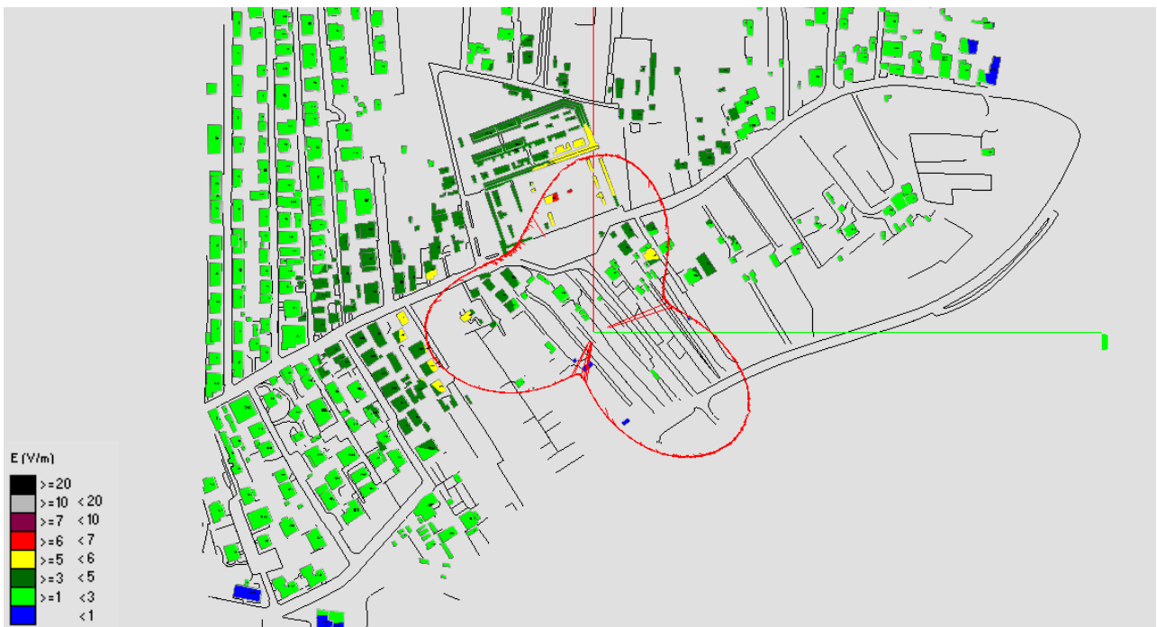
Fig. 53 Impatto elettromagnetico – Zona Area Via dei Canneti – Vista dall'alto
